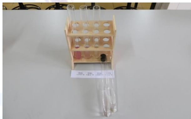
Figura 6. Tubo de ensayo con la disolución resultante del tercer enjuague.
