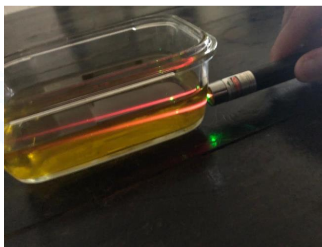
Figura 3. Detalle del rayo láser verde a su paso por la muestra de aceite de oliva.
