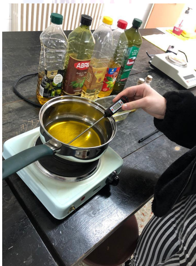
Figura 2. Montaje propuesto para la obtención del punto de humo de los distintos aceites de oliva.
